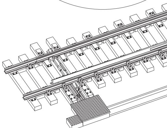
(DE) Zur Ausgestaltung des Weichenumfeldes liegen der Weiche noch weitere Teile der Weichenstelleinrichtung bei, die laut Zeichnung angebracht werden können.
